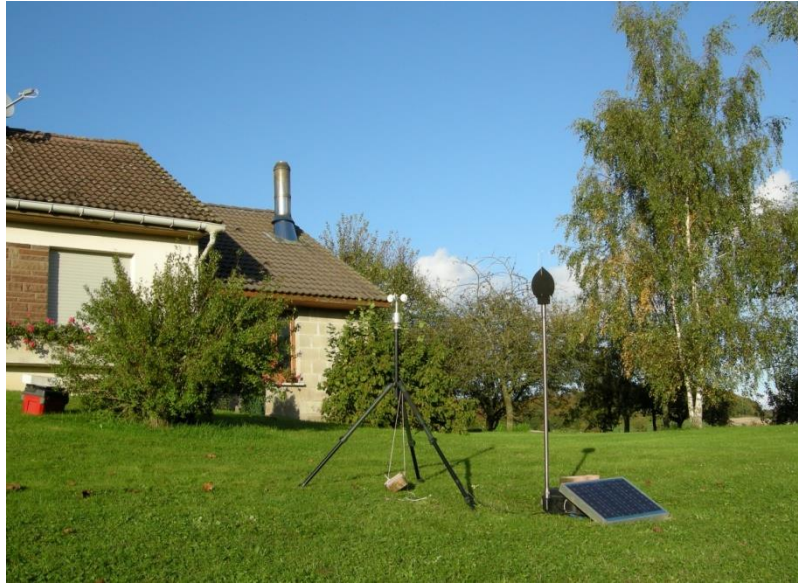
Figure 11 : Photographie d'un sonomètre en cours d'utilisation
